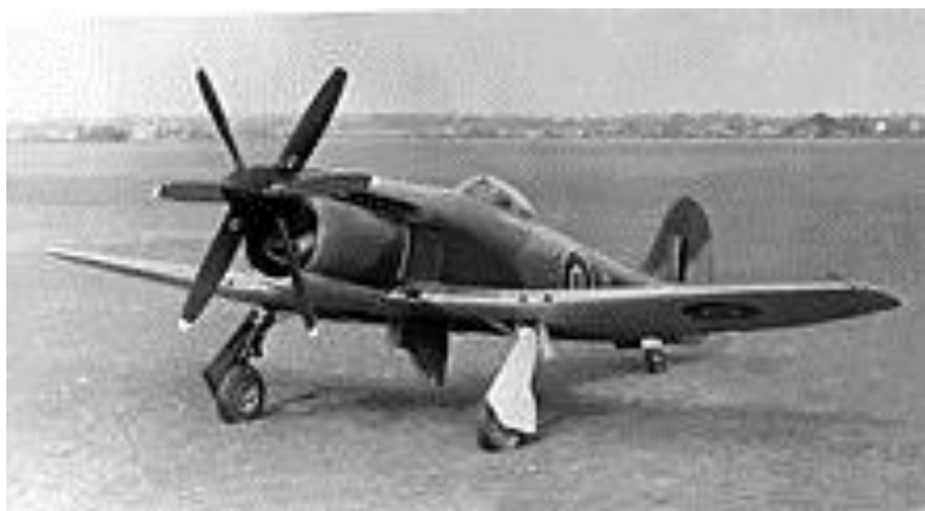
Hawker Tempest Mk III doté du moteur Griffon
