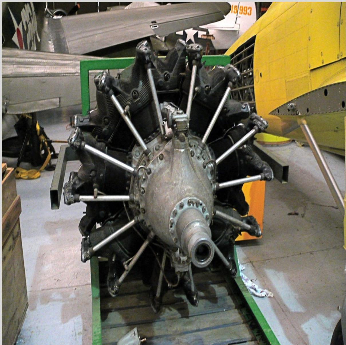
Moteur de 14 cylindres radiales sur deux lignes en étoile refroidi par air entraînant une hélice tripale à pas variable
