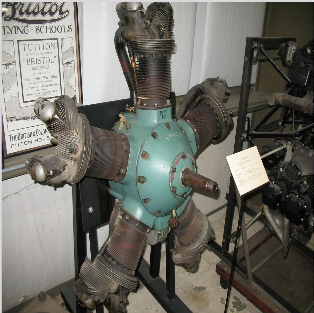
Moteur de 5 cylindres radiale en simple étoile refroidi par air
